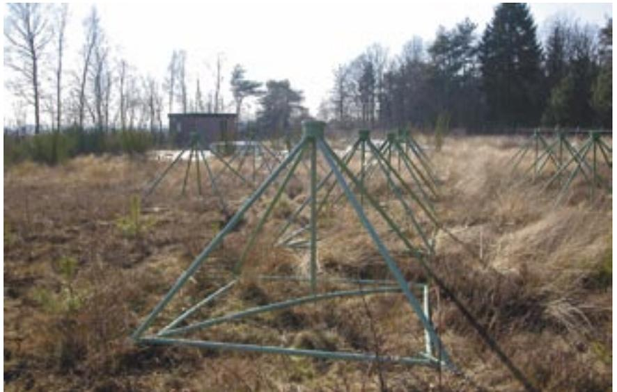
▲ Abb. 7: Oben links: Schematische Darstellung der Anordnung der Stationen von LOFAR. Der Durchmesser des Kreises beträgt 350 km. Oben rechts: Eine zukünftige LOFAR-Station (künstlerische Darstellung) besteht aus Dipolantennen des Typs »Inverted V«. Unter jeder Antenne befindet sich ein flacher runder Reflektor. Unten rechts: Photo von installierten Antennen auf einem Testfeld in Exloo, Holland.
