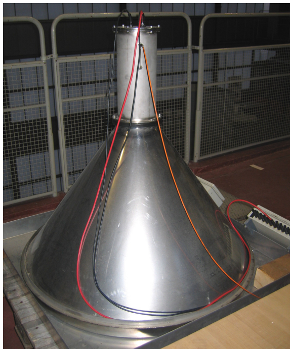
Abbildung D.1: Anordnung der Signal- und HV-Kabel des Detektors am Versuchsaufbau, so dass das Störsignal reproduzierbar reduziert werden kann. Die beiden schwarzen Kabel sind Anoden- und Dynodensignalkabel, das Rote ist das HV-Kabel.
