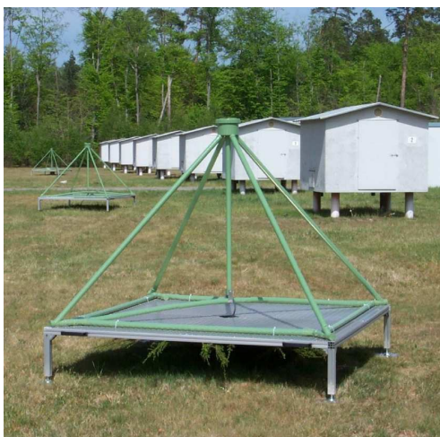
Abbildung 2.6: links : Fotografie der LOPES-Antennen zwischen den KASCADE-Hütten. rechts : invertierte V-Dipol-Antenne.
