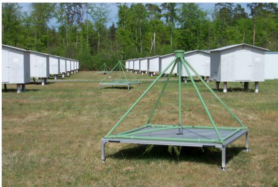
(a) Umgekehrt v-förmige Dipol Antenne von LOPES. Im Hintergrund zu sehen die einzelnen Detektorhütten von KASCADE.
