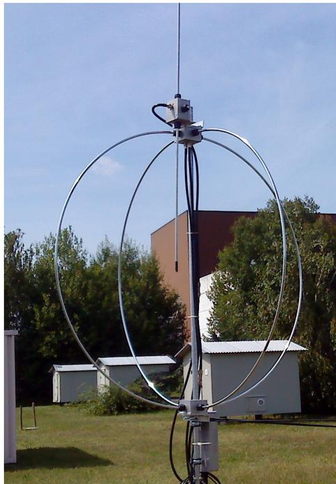
(a) Bild einer SALLA plus vertikalem Dipol im KASCADE-Feld
