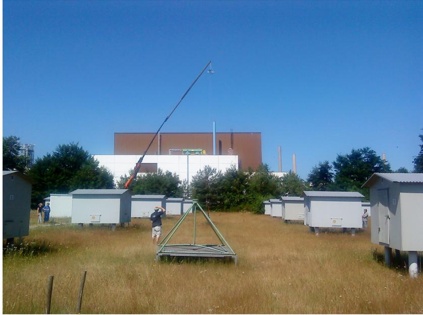
Abbildung 6.8: Amplitudenkalibrierung einer LOPES-3D Antenne mit einer Referenzquelle.
