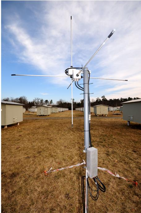
(a) Bild eines Tripols im KASCADE-Feld, gut zu erkennen die LNA-Box.
