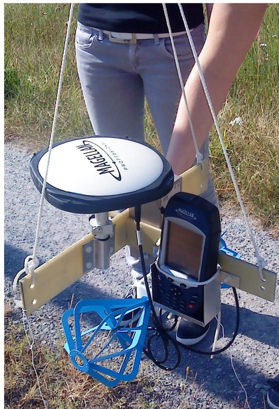
Abbildung 6.9: Referenzquelle zur Amplitudenkalibrierung, mit Sendeantenne, Frequenzgenerator und GPS System mit Antenne.
