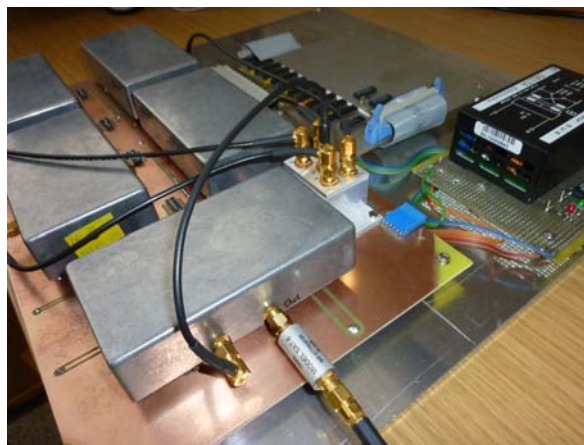
Abbildung 4.5: Frequenzgenerator. In den vier grauen Boxen links befinden sich die Quarzoszillatoren, in der fünften grauen Box im Vordergrund befindet sich der Combiner.
