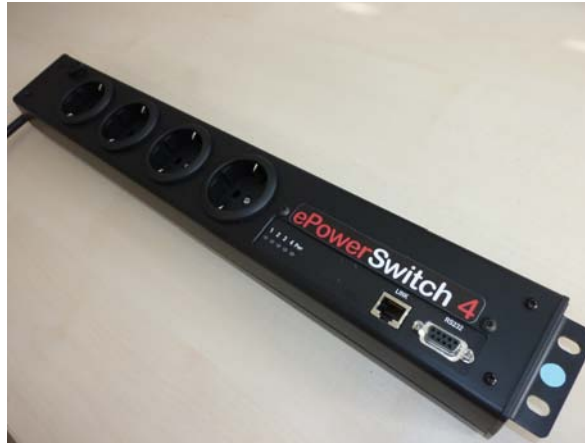
Abbildung 4.7: Ferngesteuerte Steckdosenleiste Liebert EPS-4.
