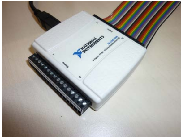
Abbildung 4.3: NI USB-6008 Interfacekarte zur Steuerung der Elektronik.
