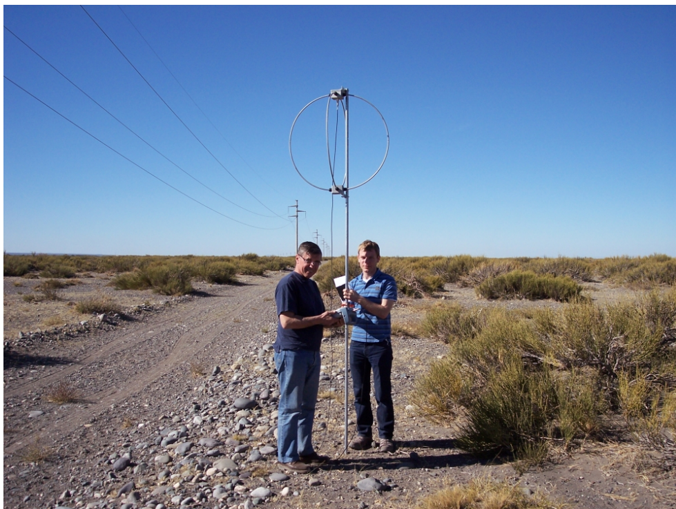
(b) An den Testpositionen wurde mit einer SALLA und einem Spectrumanalyser gemessen. Hier zu sehen ist die Testposition 5 mit der Stromleitung im Hintergrund.
