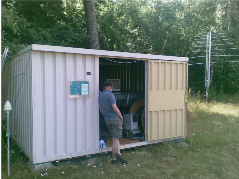
Abbildung E.4: Datenerfassung im KASCADE-Grande-Container 17 mit Center-LPDA (*hinten rechts*)
