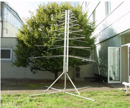
(a) Logarithmisch Periodische Dipol Antenne
