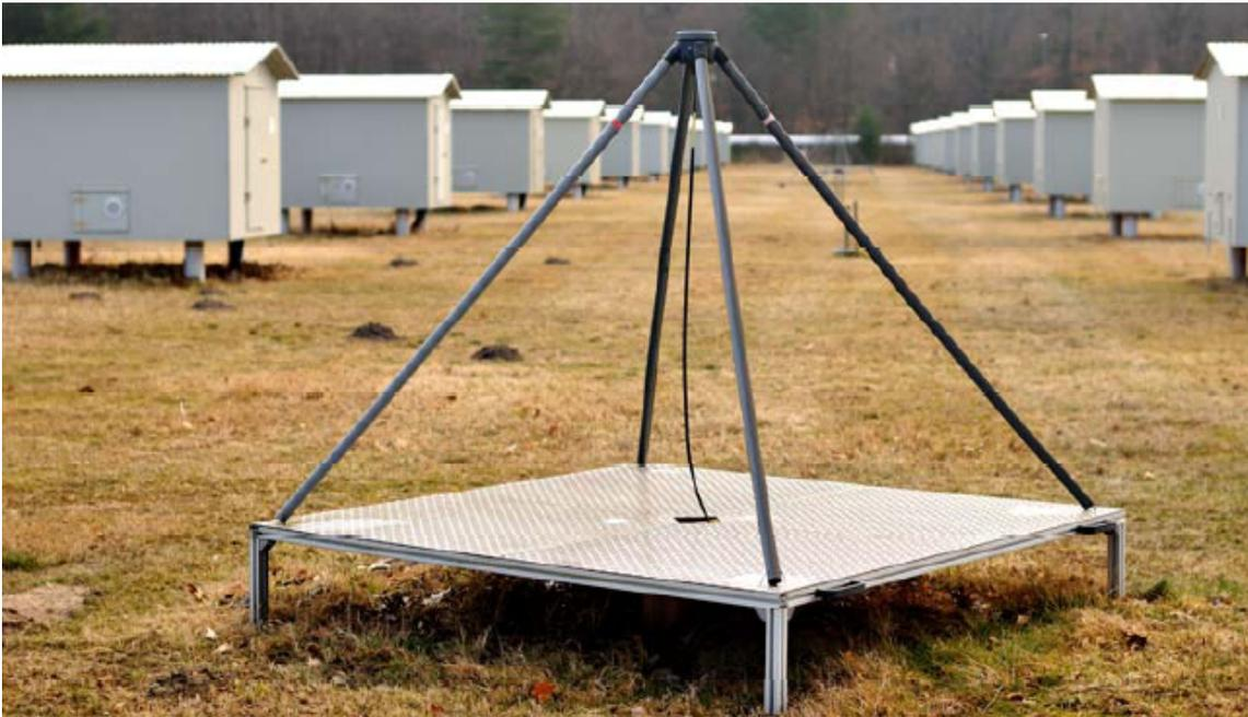
Abbildung 2.1: LOPES-Antenne, wie sie für LOPES10, LOPES30 und LOPES30pol verwendet wurden.
